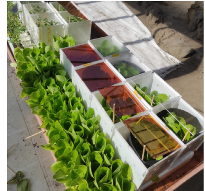
Figura 4: Test sperimentali di crescita di piante di lattuga, illuminate dalla radiazione solare filtrata da vetri spettralmente selettivi sviluppati ad hoc.
