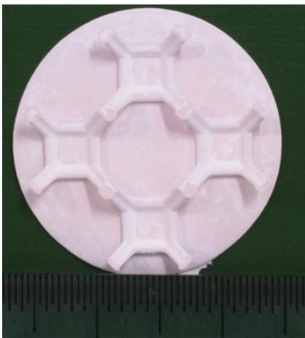
*Prova di stampa utilizzando la resina di nuova formulazione caricata con ceramico*
