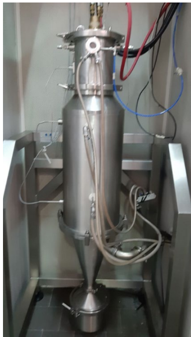
Impianto plasma termico DC
