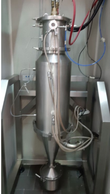
Impianto plasma termico DC
