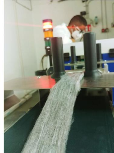
Nastro in PE+rCF utilizzabile mediante tecnologia AFP
