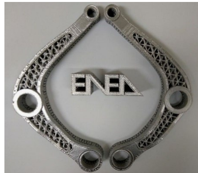
Braccetto per sospensione auto in Ti6Al4V
